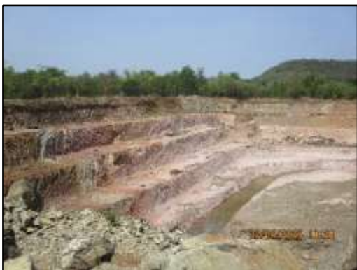
ภาพที่ 2.11 การทำเหมืองแบบชันบันได
